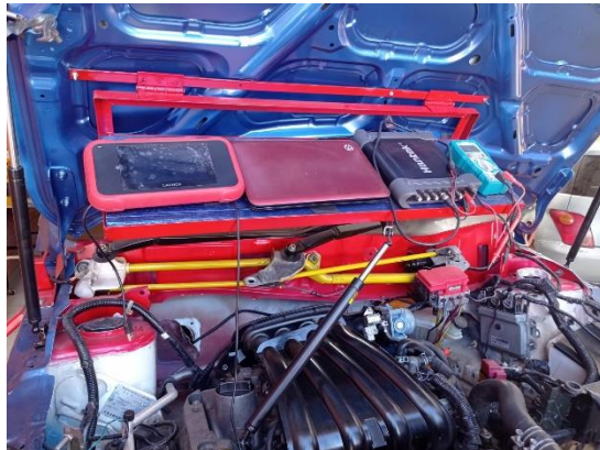
Figura Nº 20 instalación de equipos de diagnóstico
