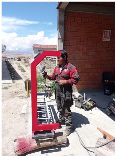
Figura N° 19 bañado de pintura a parrilla trasera
